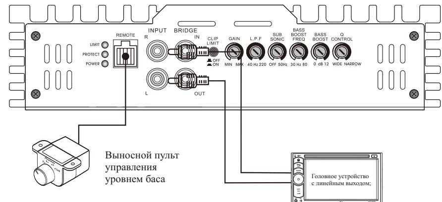
Схема подключения для двух усилителя к ГУ (схема подключение ведущего и ведомого усилителей через RCA)
